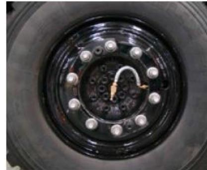
Links: Aufsteckbare Schlauchleitung, Prüf- und Füllventil zu Felge und Reifen
