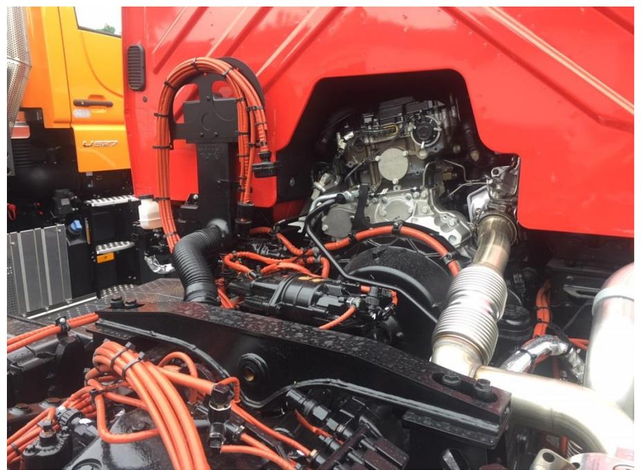
Alle Leitungen am Motor und Getriebe gegen Hitze geschützt
