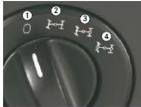
Optimale Anpassung im Gelände durch permanenten Allradantrieb und Sperren der jeweiligen Differenziale.
