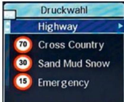
Reifendruck-Vorwahl im Display, Bedienung über Lenkradtasten
