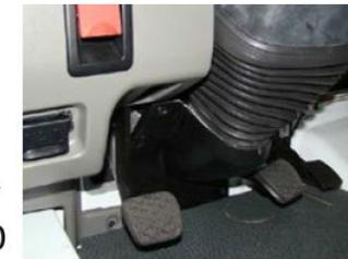
**i** Das Kupplungspedal kann in schwierigen Fahrsituationen, wie bei extremem Gelände- und Arbeitseinsatz, ausgeklappt werden, um ein sensibles Steuern zu ermöglichen. Im eingeklappten Zustand bietet das Fahren mit automatisierter Kupplungsbetätigung eine erhebliche Arbeits erleichterung.
